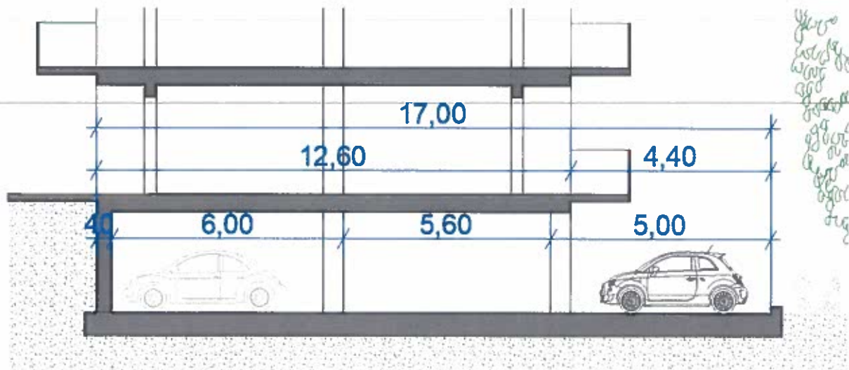
Secțiune parcare demisol
